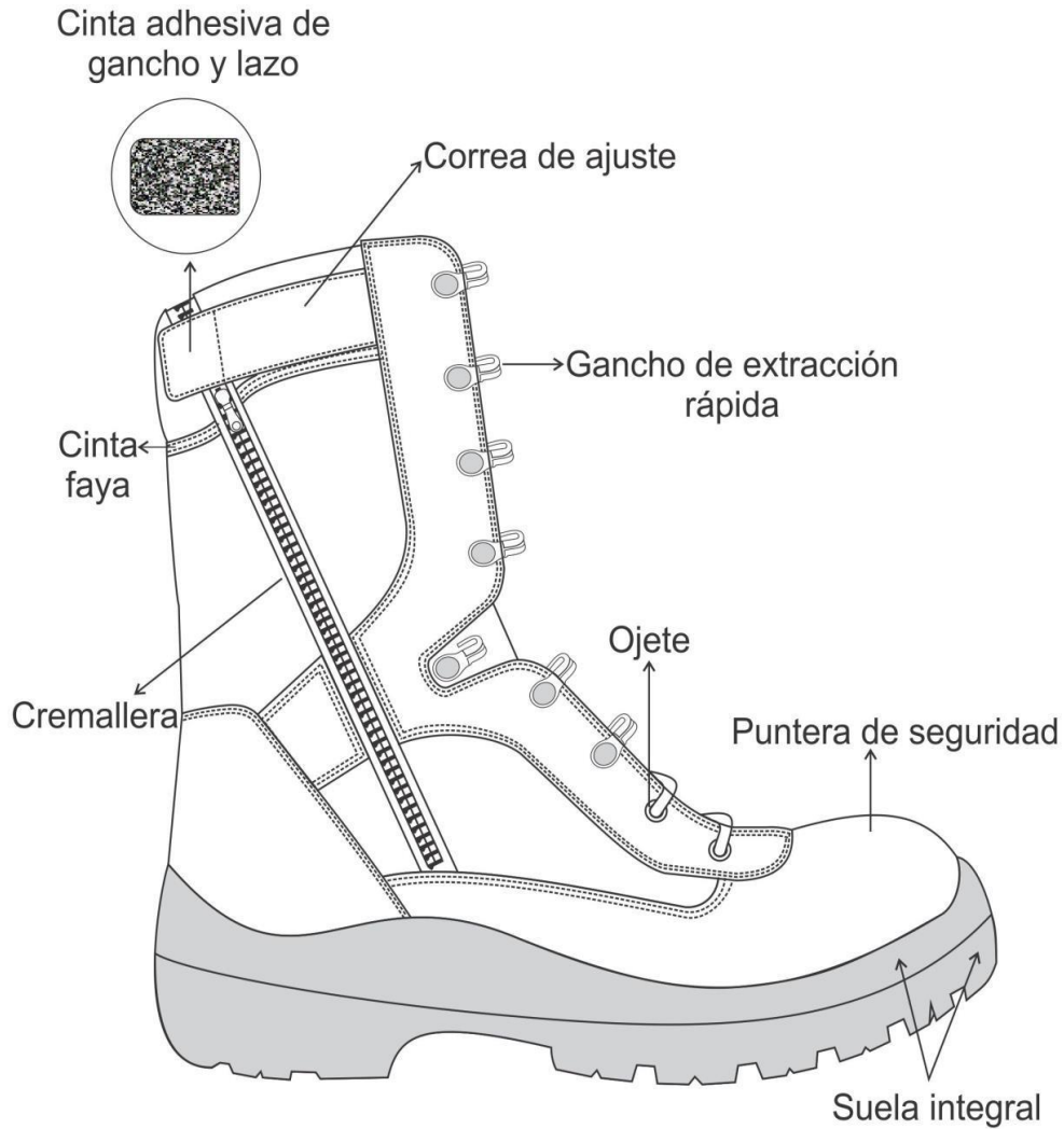
Figura 1. Vista ilustrativa lateral interno de la bota de seguridad y componentes
